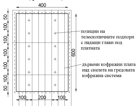
Фиг. 2.1. Разпределение на оставащите телескопични подпори в план с падащи глави
