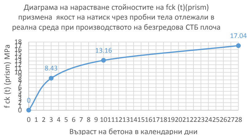
Фигура 3.107. Диаграма на нарастване стойностите на f_{ck}(t)(\text{prism}) призмена якост на натиск чрез пробни тела отлежали в реална среда
