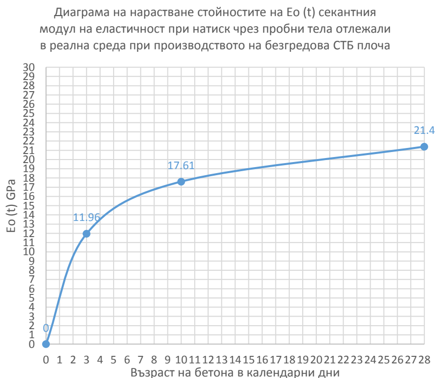
Фигура 3.109. Диаграма на нарастване стойностите на E_o(t) секантния модул на еластичност при натиск чрез пробни тела отлежали в реална среда
