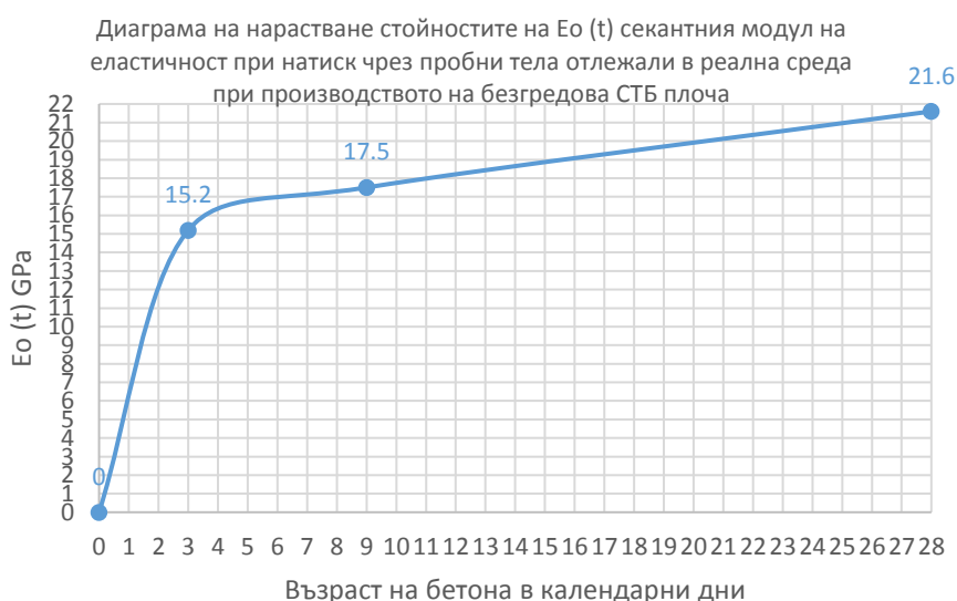
Фигура 3.104. Диаграма на нарастване стойностите на E_o(t) секантния модул на еластичност при натиск чрез пробни тела отлежали в реална среда
