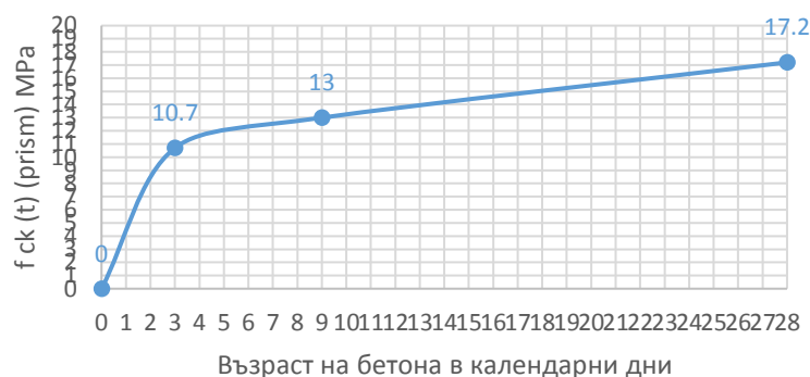
Фигура 3.103. Диаграма на нарастване стойностите на f_{ck}(t)(\text{prism}) призмена якост на натиск чрез пробни тела отлежали в реална среда
