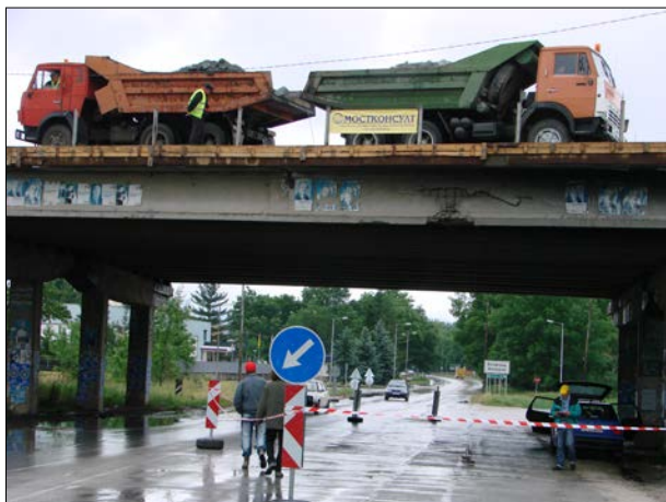
Фиг 6.8 – изпитване преди усиление
