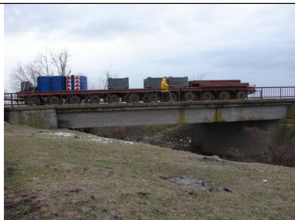
Фиг 6.21. Изпитване след усиление
