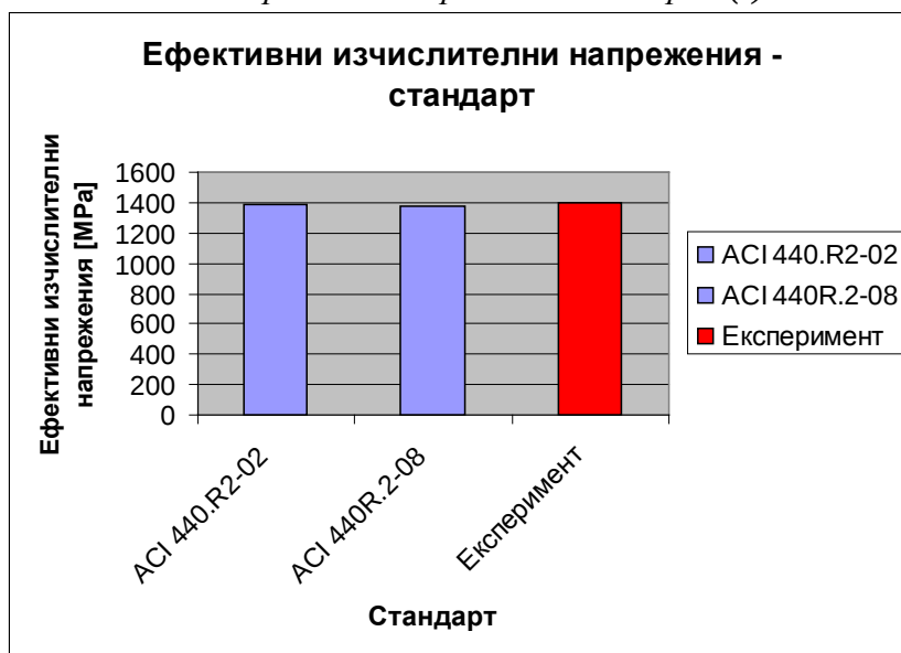
Фигура 5.3.43. Ефективни изчислителни напрежения в усиливащата система съгласно европейските стандарти и експеримента от серия (I).
