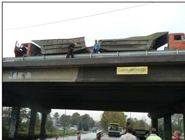
Фиг. 6.9 – изпитване след усиление
