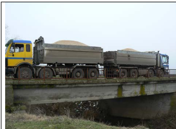
Фиг 6.20. Изпитване преди усиление
