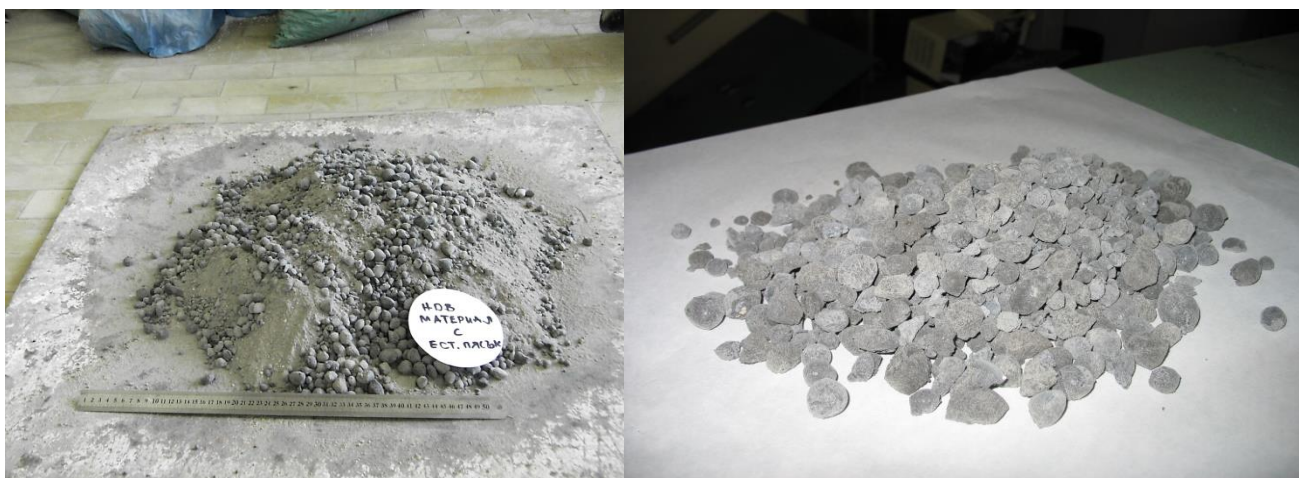
Фиг. 4.16. Подготовка на леки бетони с нов материал и естествен или перлитов пясък
