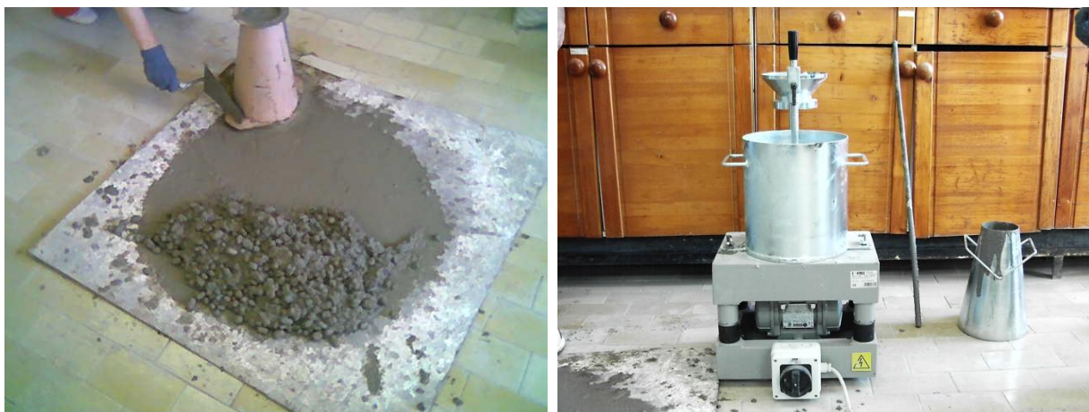
Фиг. 4.17. Подготовка и изпълнение на бетонни смеси с леки добавъчни материали
