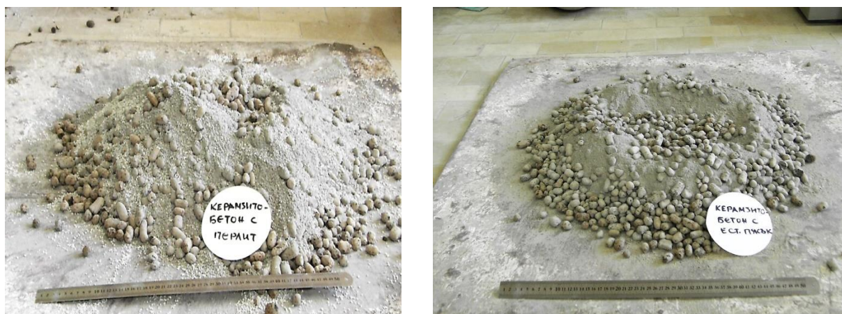
Фиг. 4.14. Подготовка на леки бетони с керамзит и естествен или перлитов пясък
