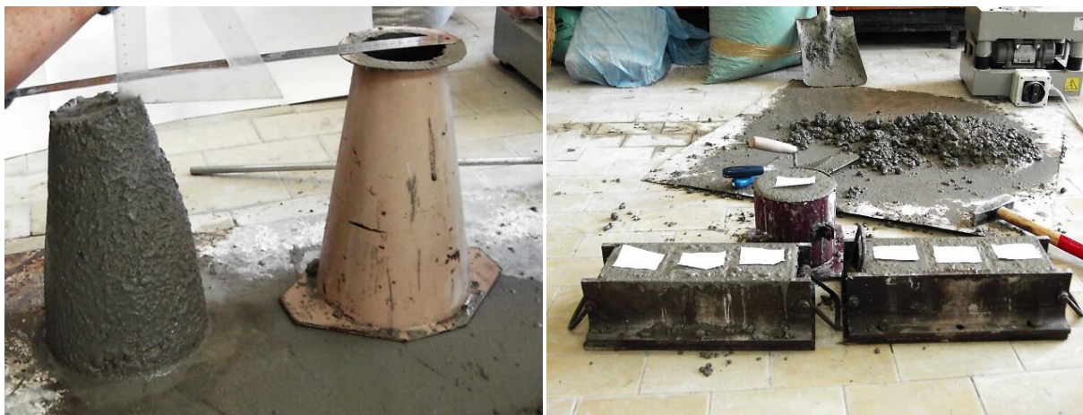
Фиг. 4.18. Подготовка и изпълнение на бетонни смеси с леки добавъчни материали
