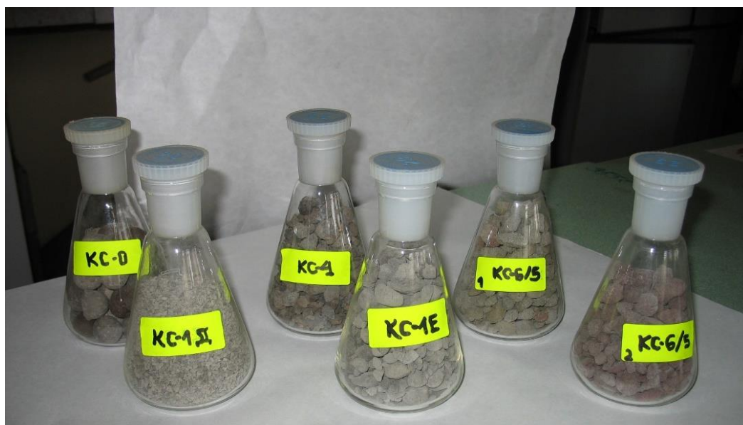
Фиг. 3.1. Леки добавъчни материали от Композитни състави КС-1÷6
